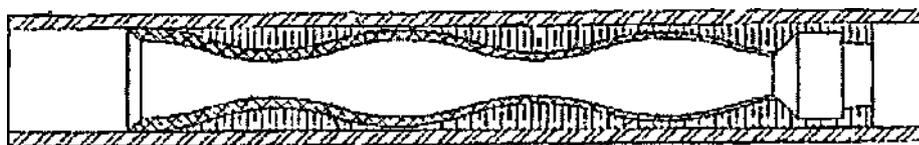
Рисунок 5 – Статор фирмы «Robbins & Myers»
